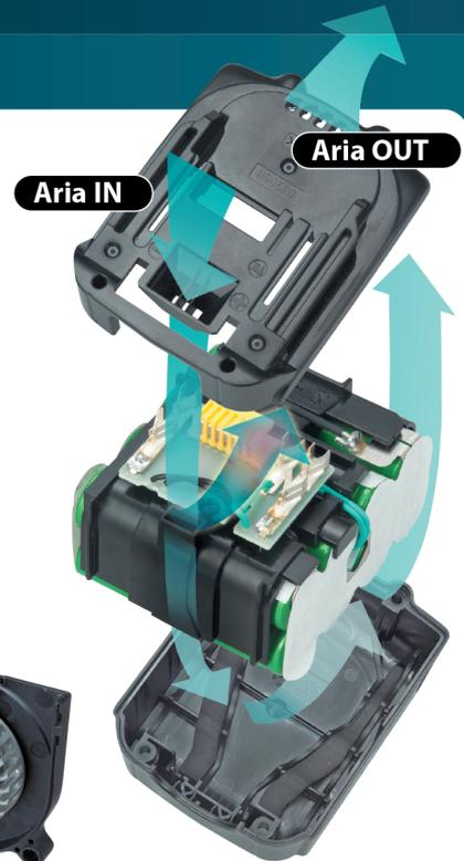
Prima di ricaricare la batteria è necessario raffreddarla perchè dopo l'uso la sua temperatura aumenta. Makita ha sviluppato uno specifico sistema di ricarica che prevede l'uso di una ventola di raffreddamento che in modo efficiente riduce i tempi di attesa per iniziare la ricarica che avviene solo a temperatura idonea. La ventola di raffreddamento è attiva anche durante la ricarica e velocizza il processo di carica.
