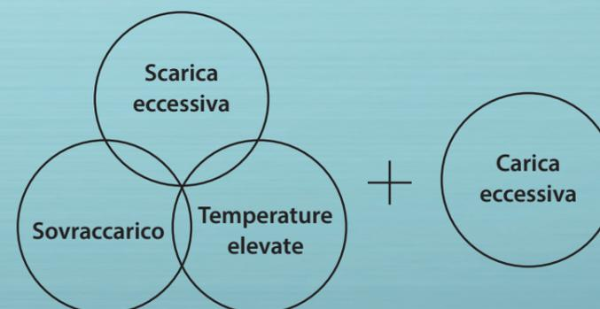
Questa funzione è una tecnologia di comunicazione che consente all'utensile e alla batteria di monitorare le condizioni e scambiare dati in tempo reale per proteggersi da sovraccarico, scarica eccessiva e surriscaldamento.
