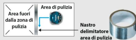
Permette all'utente di definire una superficie di pulizia delimitata utilizzando un nastro delimitatore dei confini che il Robot Pulitore non potrà oltrepassare.
