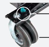
Blocco rotazione sulle ruote posteriori
