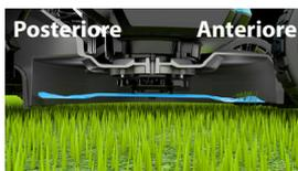
La lama è progettata in modo da inclinarsi verso la parte anteriore del rasaerba quando è collegata, impedendo il doppio taglio per un consumo di corrente ridotto.
