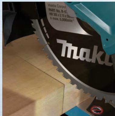
La luce LED proietta un'ombra della lama sulla superficie da tagliare. Allineando la lama con l'ombra è possibile eseguire un taglio preciso.
