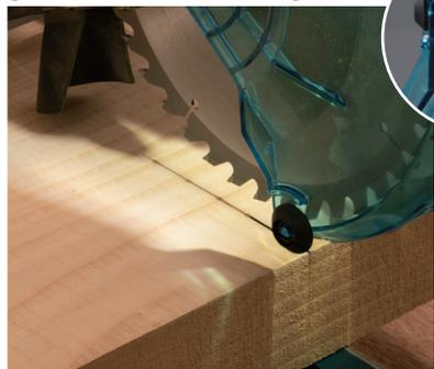
La luce LED proietta un'ombra della lama sulla superficie da tagliare. Allineando la lama con l'ombra è possibile eseguire un taglio preciso.
