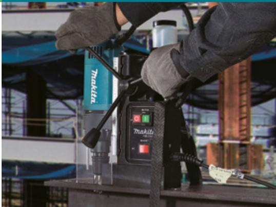
**VANTAGGI:** Trapano a base magnetica ideale per tutte le lavorazioni di foratura su acciaio in tutte le sue forme e comunque per lavorazioni anche in posa. L'elevata forza magnetica consente l'utilizzo in spazi ristretti con la massima sicurezza durante la foratura di travi in posa. HB350 segna quindi l'ampliamento di questa tipologia di macchine, insieme a HB500 sono risposta a molteplici lavorazioni in questo settore.
