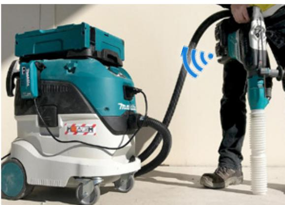
L'adattatore WUT02U consente l'accensione e lo spegnimento wireless tra utensili cordless abilitati per AWS (avvio automatico di sistemi wireless) e aspirapolveri elettrici Makita e di altri produttori. La tecnologia AWS utilizza il Bluetooth per la comunicazione on/off wireless tra l'utensile utilizzato e l'aspiratore delle polveri abbinato. La comunicazione intelligente tra gli strumenti elimina i cavi, aumenta la produttività e garantisce un ambiente di lavoro privo di polvere.
