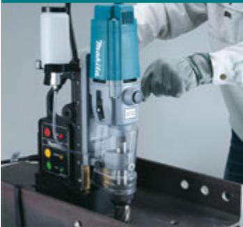
**VANTAGGI:** Ideale per foratura in posa di travi in acciaio. Permette l'esecuzione di fori direttamente in loco e non più in officina. L'elevata tenuta della base magnetica permette lavorazioni veloci e sicure.
