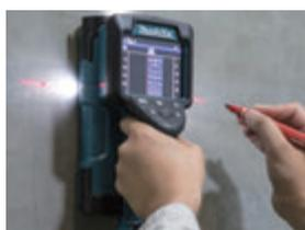
Laser di tracciamento (dx, sx), LED di illuminazione e 3 tacche di riferimento posizionamento per tracciare la posizione (dx, sx e alto)
