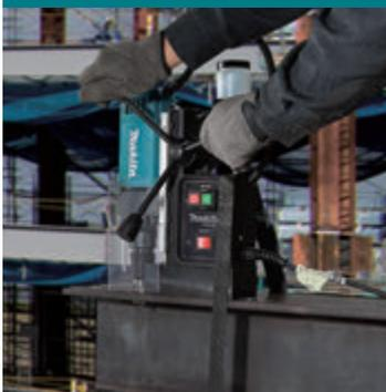
**VANTAGGI:** Trapano a base magnetica ideale per tutte le lavorazioni di foratura su acciaio in tutte le sue forme e comunque per lavorazioni anche in posa. L'elevata forza magnetica consente l'utilizzo in spazi ristretti con la massima sicurezza durante la foratura di travi in posa. HB350 segna quindi l'ampliamento di questa tipologia di macchine, insieme a HB500 sono risposta a molteplici lavorazioni in questo settore.
